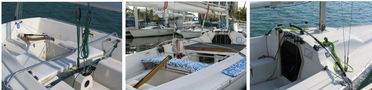
Für **Querschnittsgelähmte und Doppelbeinamputierte** ohne Prothese kann eine Bank, die beide Cockpitseiten verbindet, installiert werden. Oft werden diese Bänke in Kombination mit Haltegriffen (z. B. auf dem Kajütaufbau) verwendet, um den Seitenwechsel sicherer zu gestalten.
