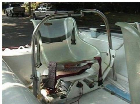
Bei breiteren Booten ist die Wippe nicht zu empfehlen. Hier eignen sich schwenkbare Sitze oder Sitze, die auf Schienen (z. B. Travellerschienen) von einer auf die andere Seite gefahren werden können.
