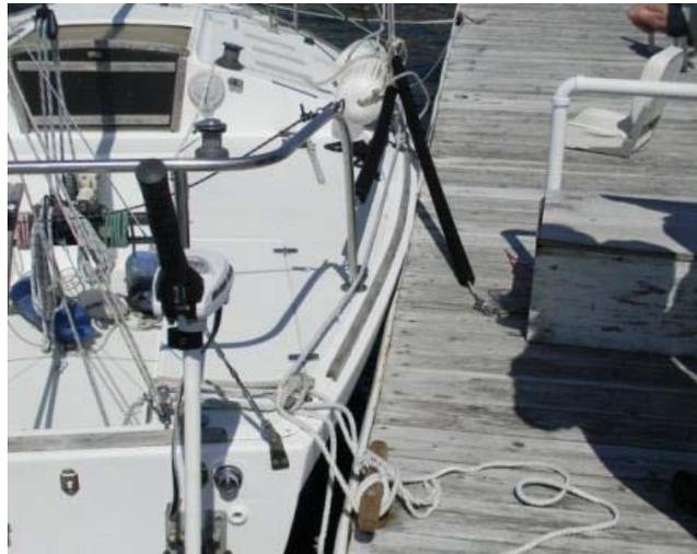
Das Deck sollte möglichst auf Höhe des Steges sein. Höhenunterschiede sollten durch Rampen, Platten oder festen Transferboxen ausgeglichen werden.
