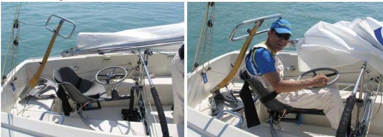
Die Radsteuerung kann auf Schwenksysteme integriert werden. Über Steuerseile wird hier ein Ruderquadrant angesteuert.
