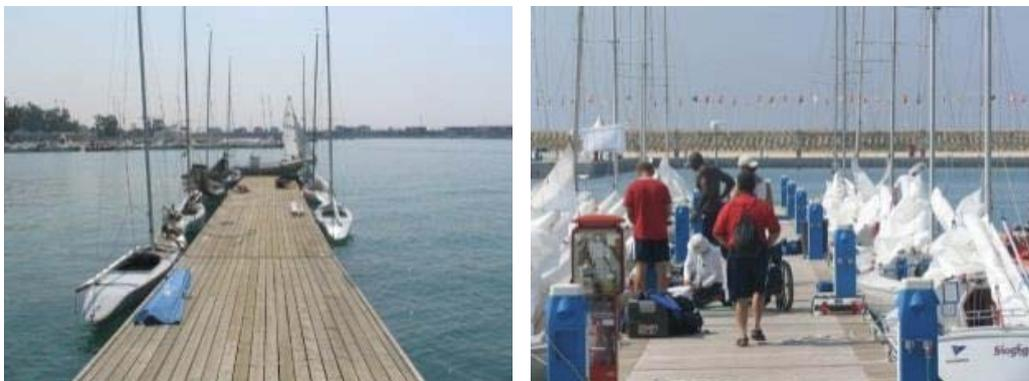
Eine Holzleiste (25mm x 25mm) entlang der Kante des Docks ist für Segler mit Sehbehinderung hilfreich. Außerdem verhindern sie, dass Rollstühle unabsichtlich ins Wasser rollen.
