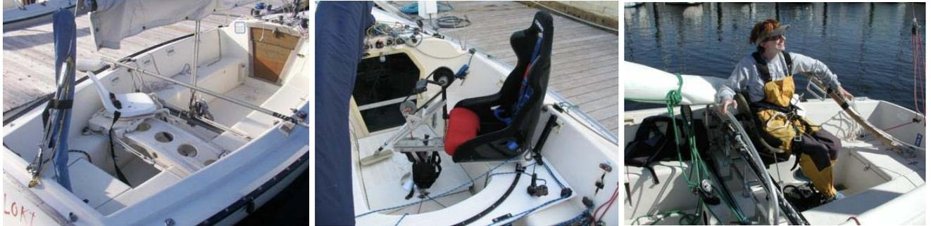
Die Sitze sollten möglichst abhängig vom Bootstyp konstruiert werden. Über einen Schwenkarm und/oder ein Schinensystem (Travellerschne und –schlitten) können die Sitze bewegt werden. Als Sitz können GoKart-Sitze oder ähnliche Sitzschalen eingesetzt werden.
