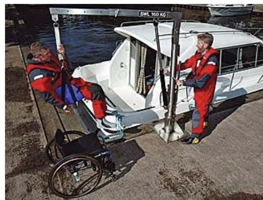
Im Idealfall, wird auf dem Steg für den Kran eine Basishalterung montiert. Dort wird der Kran nur im Bedarfsfall eingesteckt. Somit ist der Kran für die Zeit der Nichtnutzung kein Hindernis und kann geschützt untergebracht werden.
