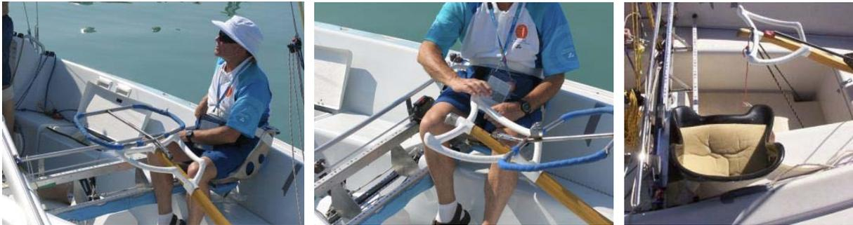
Die Pinne oder der Ausleger werden mit Bügeln versehen, die ein besseres Greifen und Halten ermöglichen.
